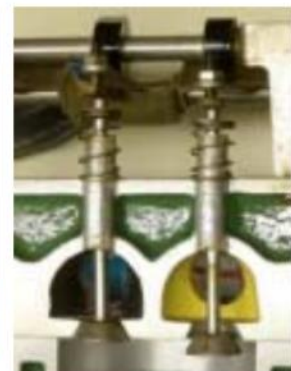
Ventil pri avtomobilskem motorju
